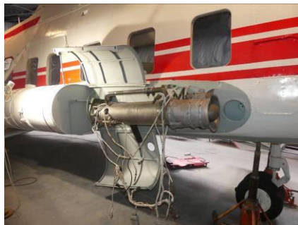
Vrtulník Mi-8 PS-9 e.č.2839 montáž a kompletácia klimatizácie, ohrevu, svetlá, príř. č. 2016/00096, ev. č. L 01264
